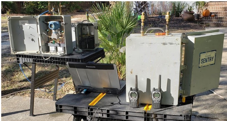
Figure 2: Débitmètres Sentry utilisés pour mesurer la vitesse et la perte de charge. À droite, le profil représentatif de l'écoulement turbulent dans une conduite
