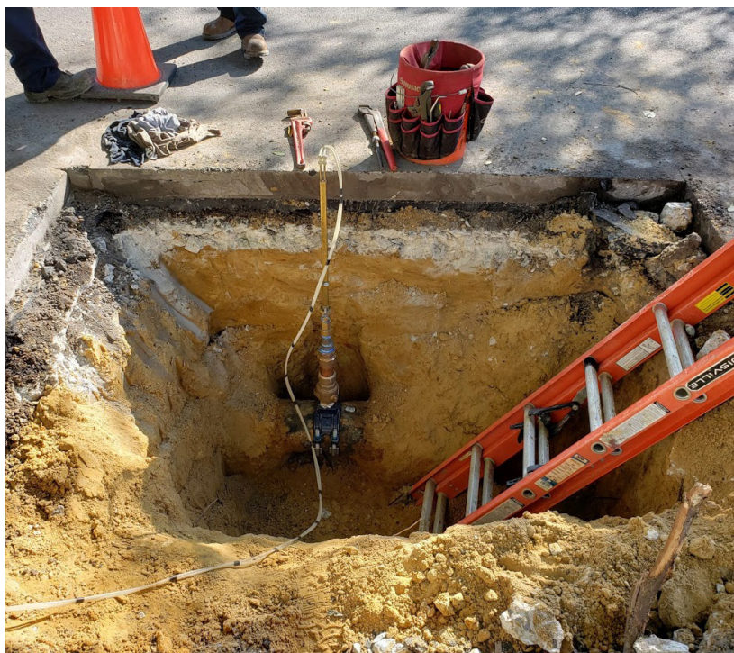
Figure 3: Tuyau taraudé avec tube de Pitot inséré. Mesures de vitesse prises en des points couvrant le diamètre intérieur du tuyau.
