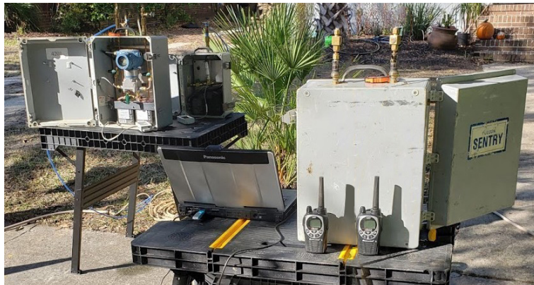
Figure 2: Débitmètres Sentry utilisés pour mesurer la vitesse et la perte de charge. À droite, le profil représentatif de l'écoulement turbulent dans une conduite
