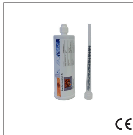
FireFree® 2K Brandtætningsskum - 2-komponent polyurethan-baseret skum til brandsikring af huller omkring gennemføringer. CE klassifikation 0761- CPD-0208/0187.
