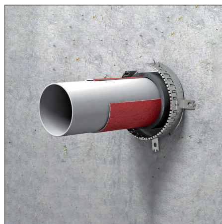
FireFree® B790 Flexbøsning - Fleksibel brandbøsning, bestående af flexbånd og rustfritstål-bånd, der tilpasses efter behov.
