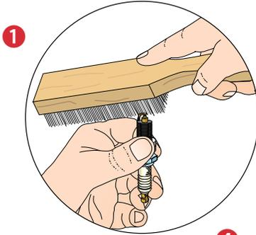
**1** S'il s'agit d'une tondeuse à essence, enlevez la bougie. Nettoyez-la à l'aide d'une brosse métallique et réglez au besoin la distance entre les électrodes (voir les prescriptions du fabricant).
