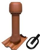
**Ventilācijas izvads** – Speciāls elements, parasti dakstiņa formā ar iestrādātu caurules pieslēgumu no apakšas, kas ļauj uz jumta izvadīt gaisu no ventilācijas kanāliem (kanalizācijas stāvvada vēdināšanai, tvaika nosūcējam, telpu ventilācijai, rekuperācijas gaisa apmaiņas iekārtu pieslēgumiem utt.) Alternatīva veidot izgriezumus dakstiņos un izmantot blīvēšanas materiālus. Riski – mezgla hermētiskums, vizuālā izskata bojājums.
