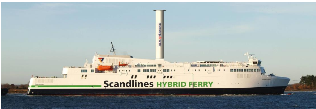
Valokuvamallinnus M/V Copenhagen matkustajalautasta roottoripurje asennettuna.
