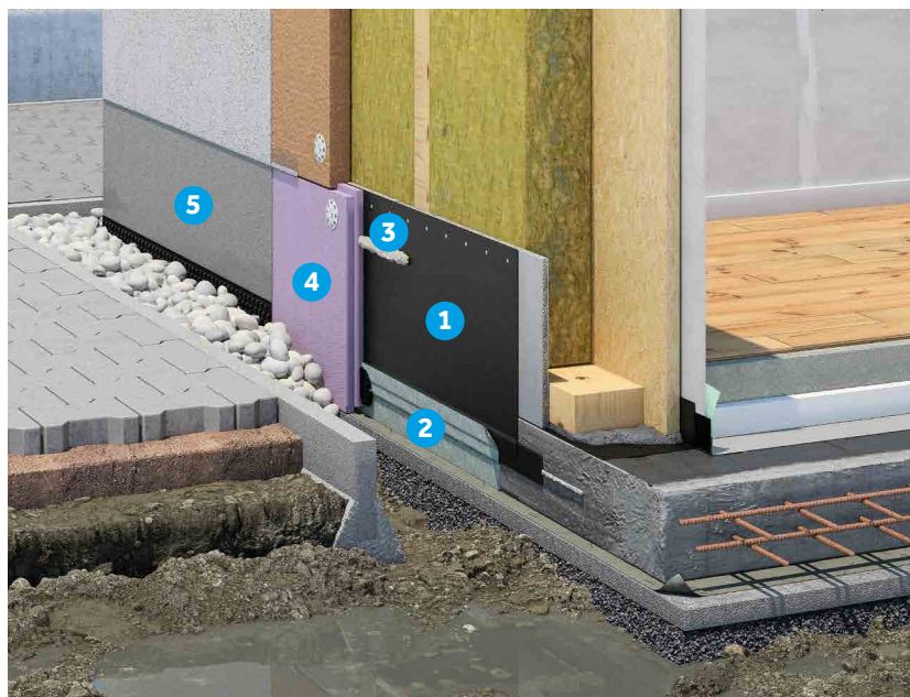
Bauwerksabdichtung im Neubau.
