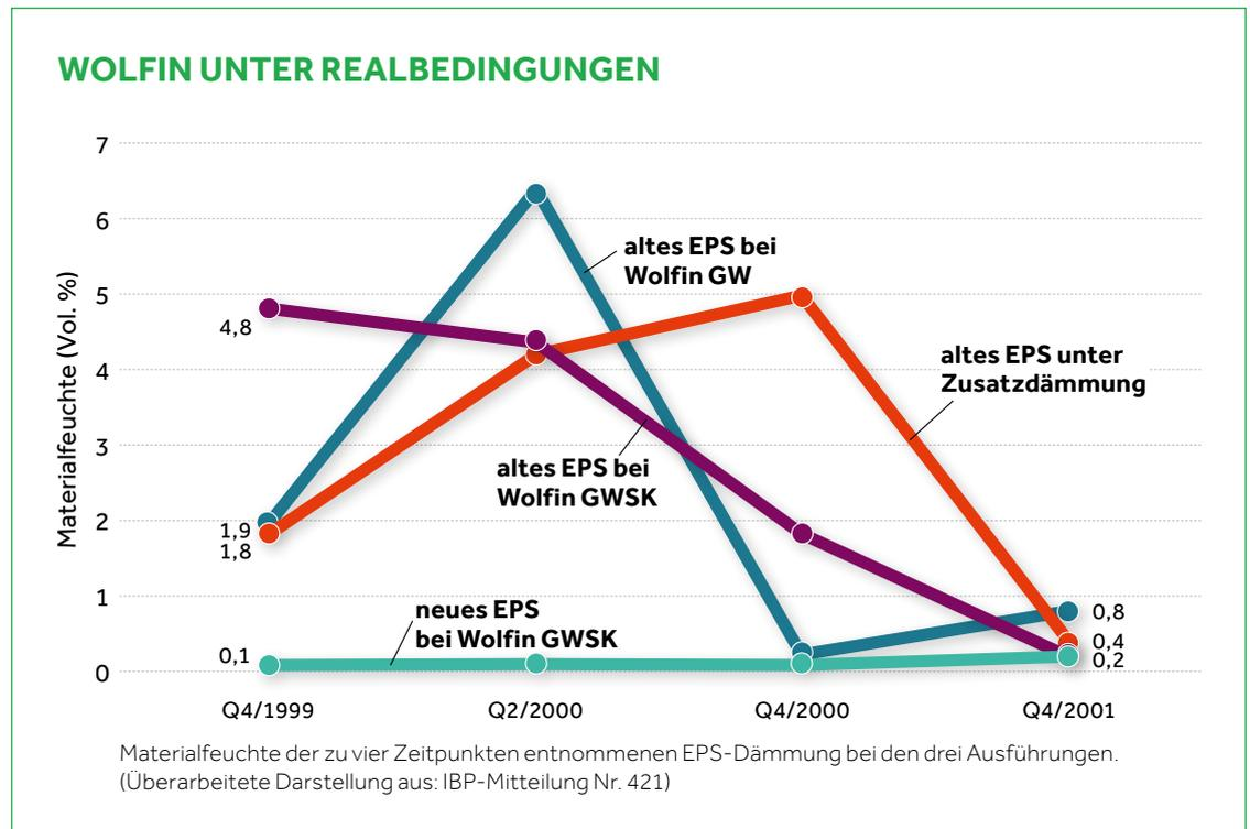
Das Fraunhofer-Institut für Bauphysik hat in Holzkirchen eine Versuchsreihe durchgeführt, bei der Wolfin Kunststoff-Dach- und -Dichtungsbahnen zwischen Dezember 1999 und Februar 2002 im Freiland, also unter Realbedingungen, getestet wurden. Zum Einsatz kamen folgende Top-Produkte unter den Kunststoffbahnen:
