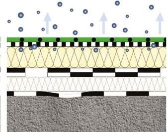
Das Dach trocknet vollständig aus. In der Untersuchung des Fraunhofer Instituts erfolgte die Austrocknung in ca. 2 Jahren.
