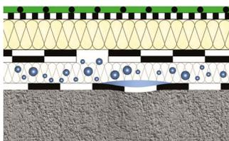
Erhalt des alten Dachschrichtenpakets, Perforation der bestehenden Abdichtung (5 Löcher/m<sup>2</sup> – Durchmesser ca. 25 mm) und ggf. Aufbringen zusätzlicher Dämmung nach GEG und Dachabdichtung mit Wolfin (Farbe schwarz).
