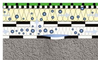
Durch die schwarze Farbe der Wolfin Bahn beginnt eine Erwärmung des Dachschrichtenpakets. Die Feuchtigkeit verteilt sich zunächst im Schichtenpaket.
