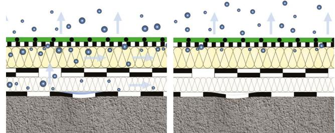
Durch die gleichmäßige horizontale Verteilung der Feuchtigkeit im Dämmstoffpaket wird die gesamte Fläche der Wolfin Abdichtung für die Austrocknung genutzt. Die Austrocknungsgeschwindigkeit steigt.
