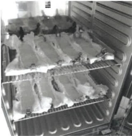
Images 3 et 4: Etuvage des couches imprégnées et pressage des couches par une machine de compression mécanique (SLC) 2 •
