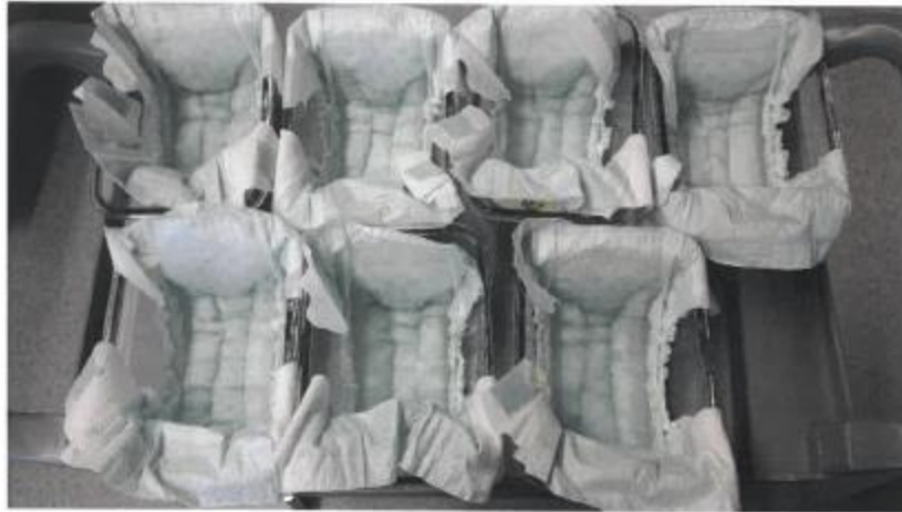
Photo 12 : Échantillons après 16 h dans une étuve à 37° C
