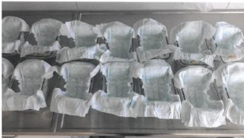
Photo 8 : Échantillons préparés pour le test de lixiviation
