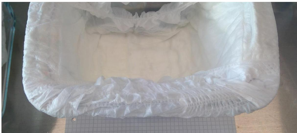
**Photo 1: Couches-culottes préparées pour le test du scénario d'exposition (échantillons sans solution d'urine)**
