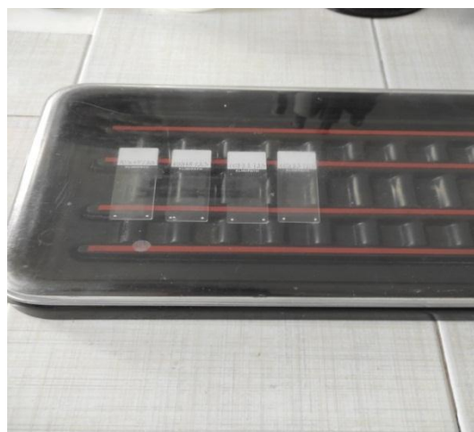
Фигура 3. Влажна камера за инкубация на препарати при ИХХ изследвания. Капацитета ѝ е 20 стъкла. Има улей за оттичане на водата, както и гумени противоплъзгащи ленти, които позволяват камерката да се накланя до ъгъл от 45°. Това е от голямо удобство, когато трябва да се извършва струйно промиване на препаратите.
