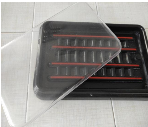
Фигура 3. Влажна камера за инкубация на препарати при ИХХ изследвания. Капацитета ѝ е 20 стъкла. Има улей за оттичане на водата, както и гумени противоплъзгащи ленти, които позволяват камерката да се накланя до ъгъл от 45°. Това е от голямо удобство, когато трябва да се извършва струйно промиване на препаратите.
