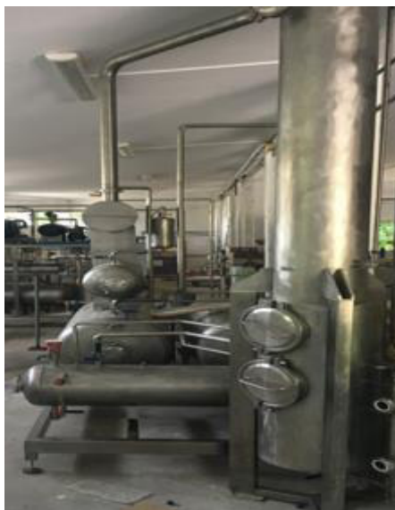
Фиг. 1. Инсталация за водно-спиртна екстракция
