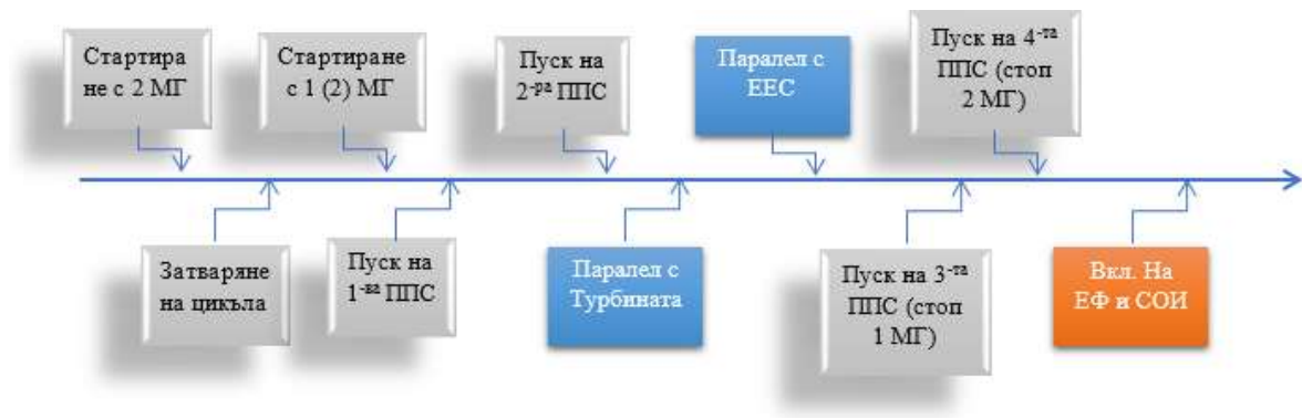
Фигура 2.1. Алгоритъм за пуск от студено състояние на котли ПК-38-4, при разпалване с мазут
