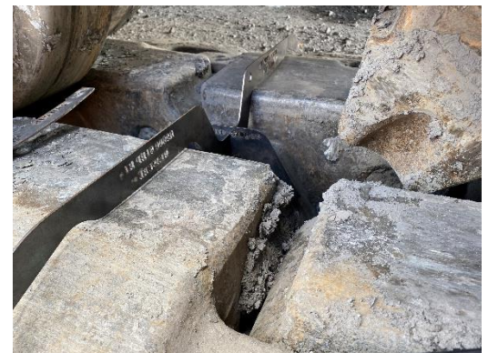
Desgaste a las 11 000 horas.
