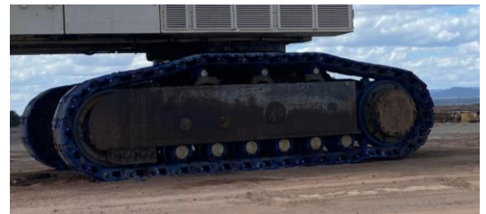
Zapatas nuevas en la máquina.
