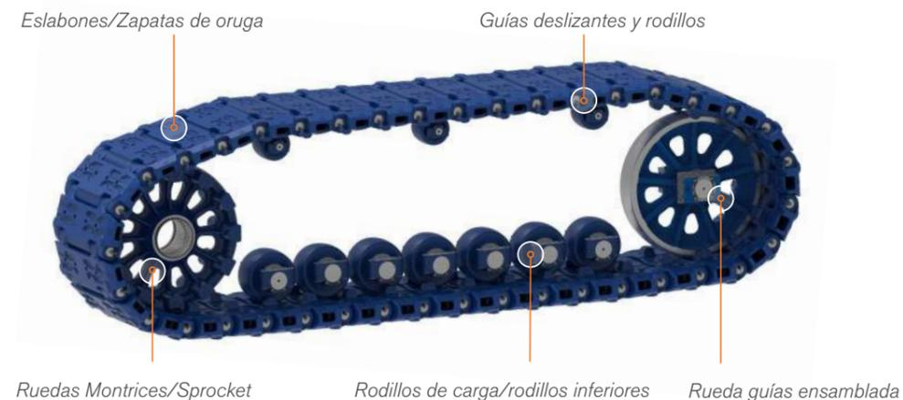
**Bradken diseña y fabrica soluciones de tren de rodaje para palas eléctricas de cable y excavadoras hidráulicas para el sector de minería. Nuestra reputación como proveedor de productos confiables y de alta calidad se evidencia a lo largo de décadas de suministro a los mercados mineros alrededor del mundo.**
