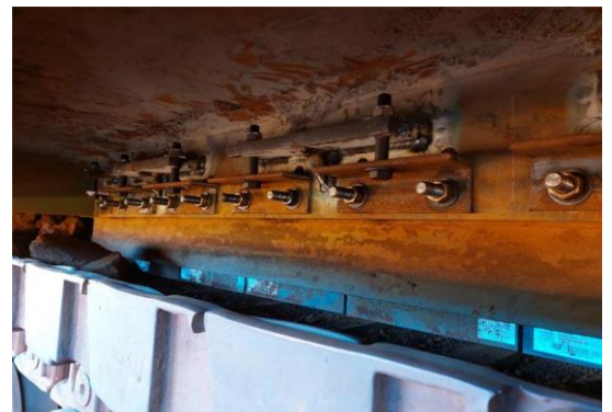
Soportes ajustables del revestimiento del faldón.
