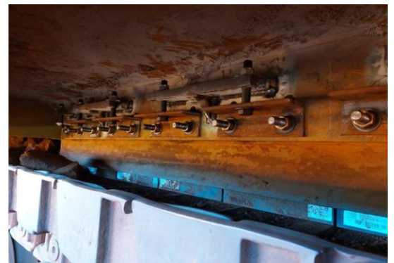
Soportes ajustables del revestimiento del faldón.
