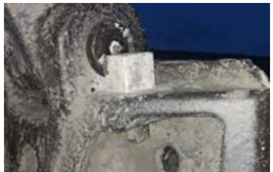
Matériel de rétention des broches mis à niveau par Bradken
