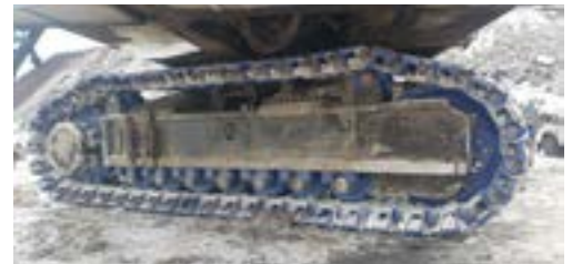
Le système Wide Roller Path (WRP) de Bradken est installé
