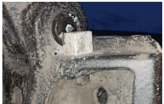
Hardware de retenção do pino aperfeiçoado da Bradken
