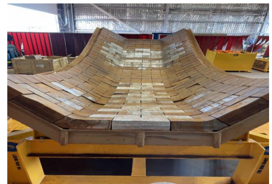
Nuevos bloques del kit de zona de alto desgaste (plata/tal como se funde) instalado en el deflector renovado.
