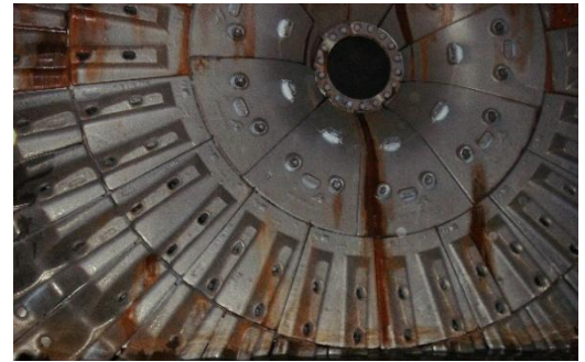
Desgaste mínimo do Bullnose® da Bradken após 23 meses
