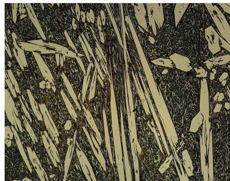
Микроструктура Duaplate D60
