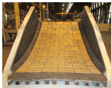
Calha de escoamento revestida com Duablock
