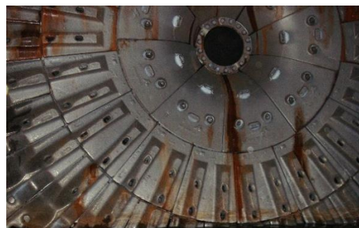
Desgaste mínimo del Bullnose® De Bradken a los 23 meses
