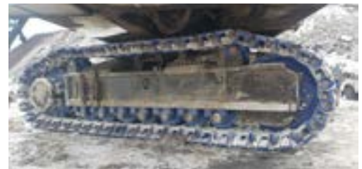
Se instaló el tren de rodaje de tramo ancho (WRP) de Bradken
