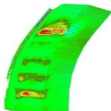
Mapa de calor do monitoramento de condições que destaca áreas de alto desgaste do defletor em amarelo e vermelho. Visualização direcionada à extremidade de descarga.
