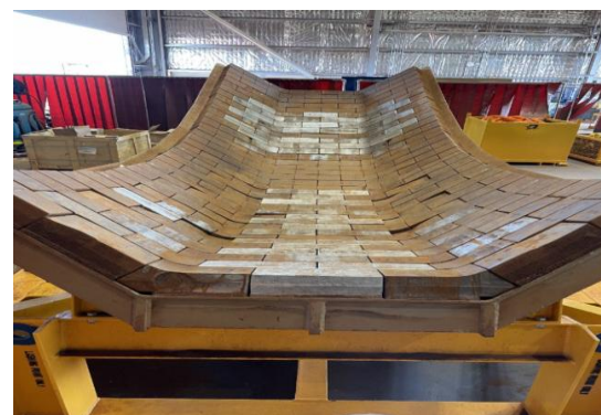
Novos blocos do kit da área de alto desgaste (prata/no estado fundido) instalado no defletor reformado.
