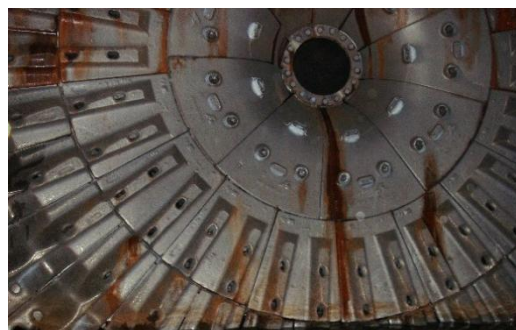
Usure minimale du Bullnose® de Bradken au bout de 23 mois
