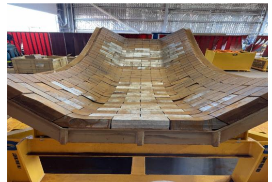
Nouveaux blocs du kit d'endroits soumis à une usure élevée (argent/en fonte) installés dans le déflecteur remis à neuf.
