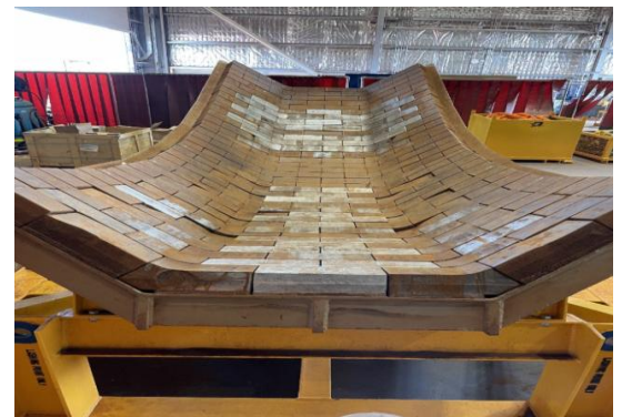
Nouveaux blocs du kit d'endroits soumis à une usure élevée
