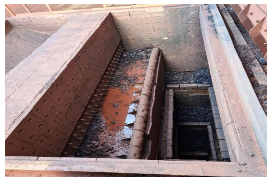
Тесное пространство с несколькими глубокими уровнями, что затрудняет подъем тяжелых элементов обшивки по одному.
