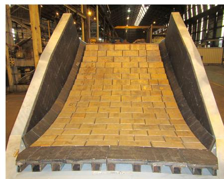
Conducto revestido con Duablock
