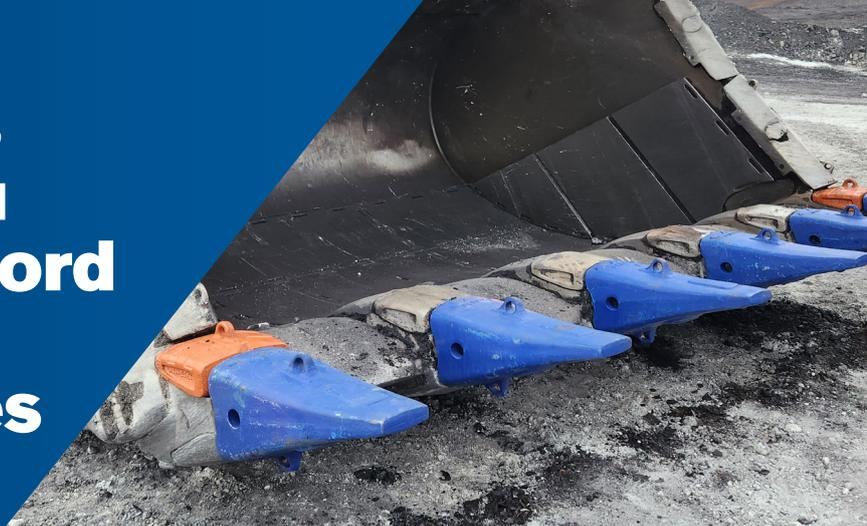
Les outils d'attaque du sol pour godet à bord droit Zénith® sont conçus pour minimiser l'énergie nécessaire pour le creusement requise pour la pénétration et prolonger la durée de vie des pointes.
