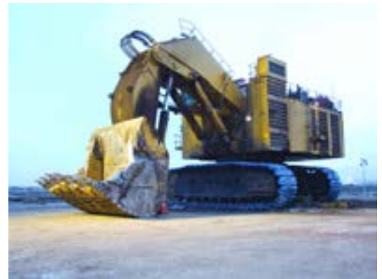
Pelle excavatrice PC8000
