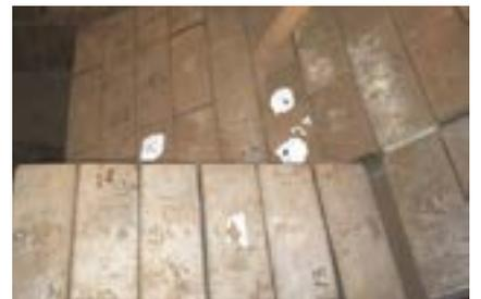
Revestimientos Dualblock 80/20 con SmartLiner instalado
