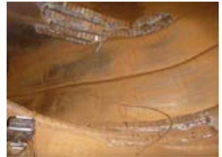
Revestimientos de acero resistente a la abrasión gastados, con reparaciones
