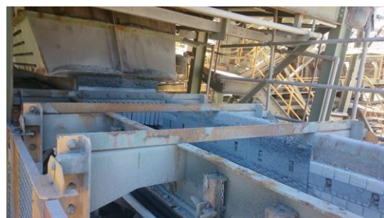
Conducto de descarga con revestimiento para faldones
