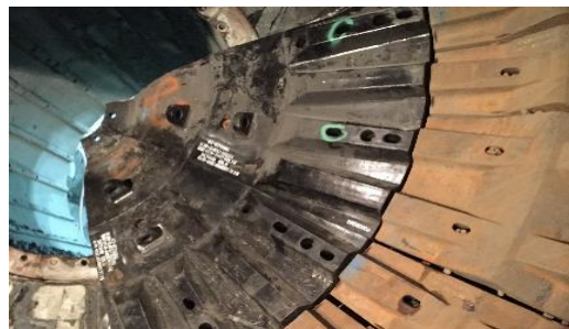
Процесс установки 1го сегмента из 9 частей 9-сегментной-системы
