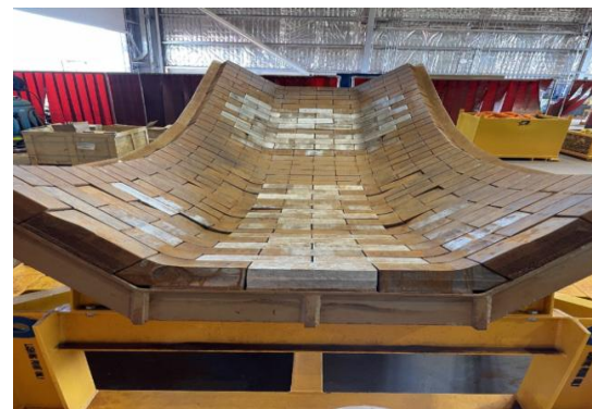
Новые блоки комплекта для зоны высокого износа установлены на дефлектор после реконструкции.
