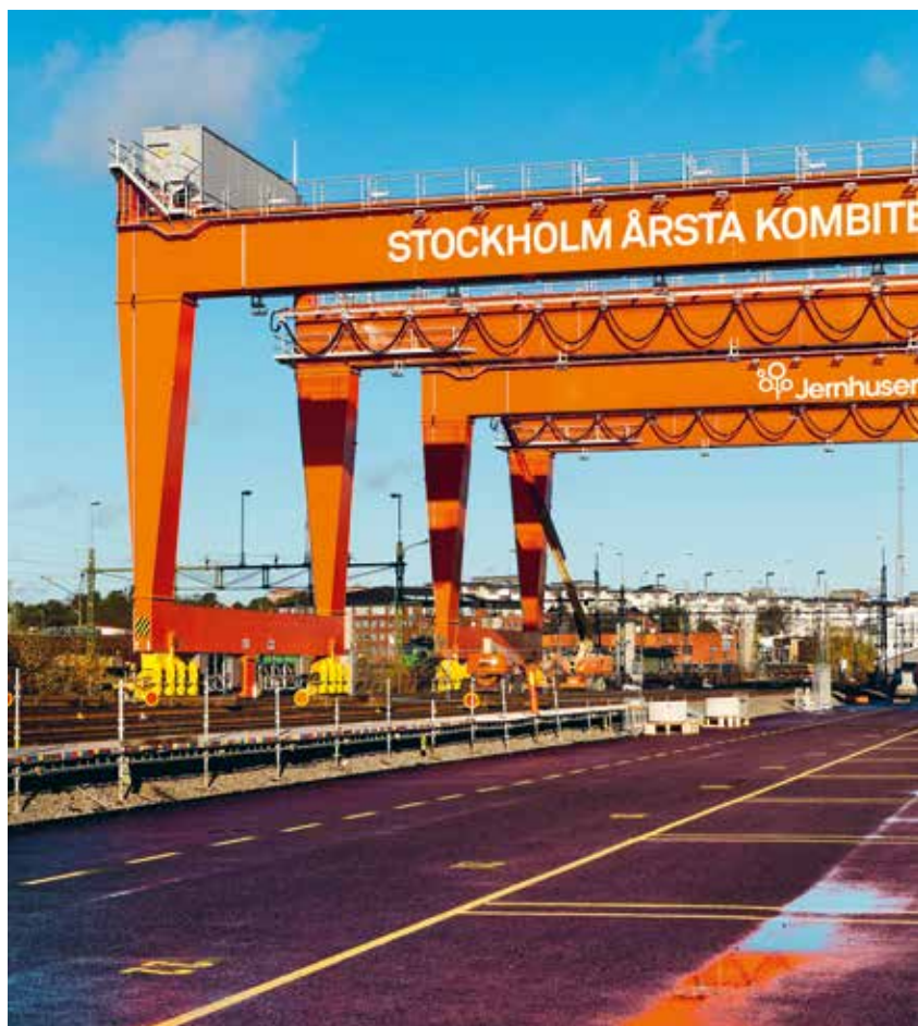
Två stora portalkranar på Stockholm Årsta Kombiterminal gör att större volymer kan hanteras än med traditionella truckar. Utsläppen minskar också och elektricitet genereras när lasten sänks.
