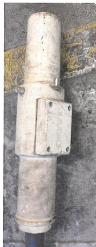
Bild 2: Kopplingspropp med pilotstift
