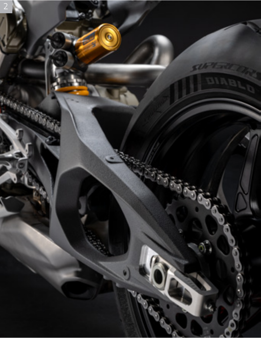
2 Unidad Öhlins TTX36 (SV) S-EC 3.0 completamente regulable. Ajuste electrónico de la compresión y el rebote con modo Öhlins Smart EC 3.0 basado en eventos. Basculante simétrico de aluminio hueco
