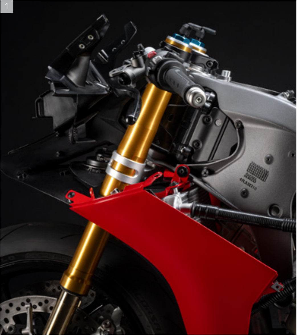
1 Horquilla Öhlins NPX 25/30 (SV) S-EC 3.0 presurizada de 43 mm completamente regulable con tratamiento TiN. Ajuste electrónico de la compresión y el rebote con el modo Öhlins Smart EC 3.0 basado en eventos
