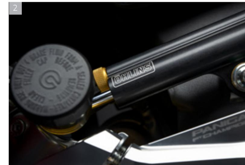
2 Amortiguador de dirección Öhlins regulable
