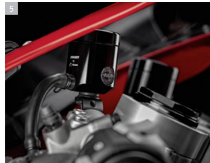
5 Depósito del líquido de embrague y de freno.
