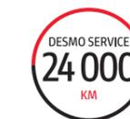
Indicación del kilometraje del primer Desmo Service, o sea la revisión durante la que se efectúa, entre otras cosas, el control y, en caso necesario, el reglaje de las válvulas.
