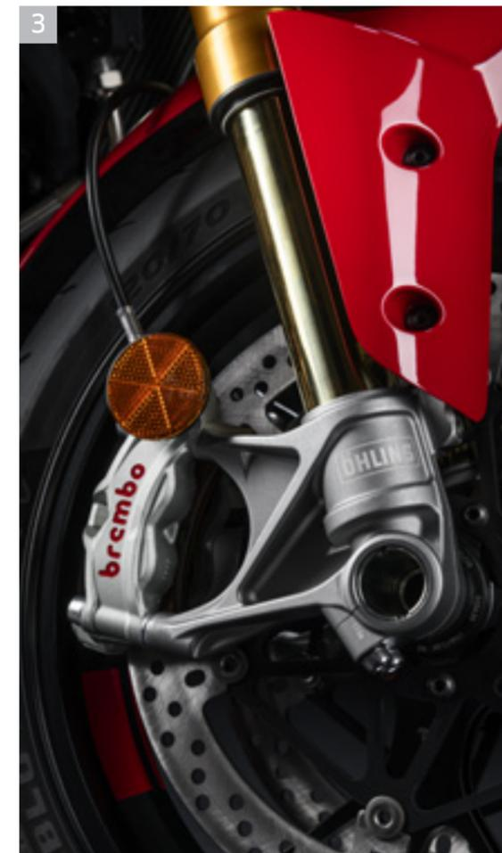
3 Amortiguador electrónico Öhlins Smart EC 2.0
