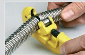
1) Гъвкавата връзка се срязва във вдлъбнатата част с резачка за тръби.
