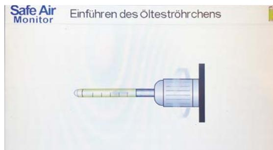
Sobald das Instrument seine Spülsequenz abgeschlossen hat, werden Sie aufgefordert, das Röhrchen in den Testanschluss hineinzustecken und fest anzuziehen.
