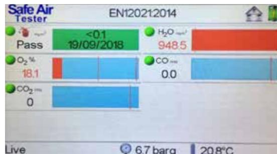
Wenn Sie längere Zeit in dieser Betriebsart laufen, empfehlen wir Ihnen, das Gerät an das Stromnetz anzuschließen. Beachten Sie außerdem, dass der Taupunktsensor speziell für die Genauigkeit über einen fixen Testzeitraum von kurzer Dauer ausgelegt ist. Bei Systemen mit einem Taupunkt von  $\geq -55^{\circ}\text{C}$  PDP liefert das Instrument weiterhin genaue Messungen.
