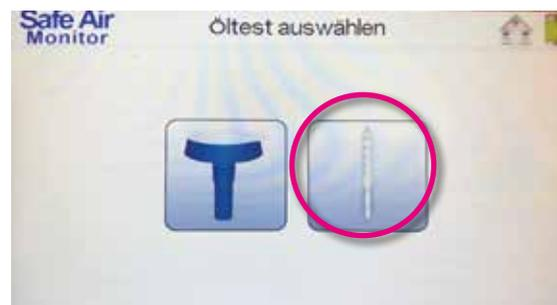
Wenn Sie wissen, welches Schmiermittel für den Kompressor verwendet wird, nutzen Sie die Tabelle „Testzeiten“ auf der für den F8004 gekennzeichneten Factair-Website. Wenn Sie nicht wissen, welche Art von Kompressorschmiermittel im Atemluftsystem verwendet wird, empfehlen wir eine Testzeit von 15 Minuten, da dies die überwiegende Mehrheit der Schmiermittel abdeckt.
