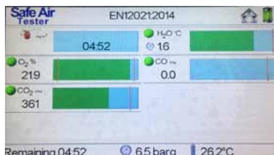
Sobald der Test abgeschlossen ist, wird der Impaktor-Ergebnisbildschirm angezeigt. Schließen Sie das Durchflussregelventil. Der Impaktor sollte nun aus dem Testanschluss entnommen, der Aufkleber entfernt und ausgewertet werden. Um die Ergebnisse einzugeben, drücken Sie das entsprechende Symbol auf dem Bildschirm.
