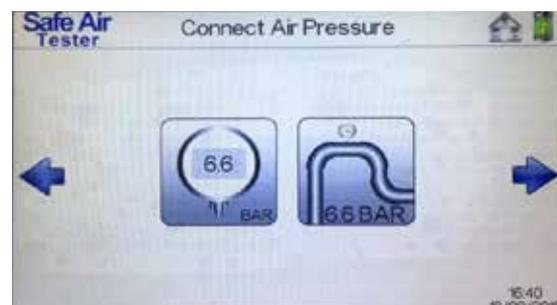
*Hinweis: Wenn das Gerät unter Überdruck steht, wird es automatisch heruntergefahren und zeigt eine Überdruckwarnung an. Es muss dann zur Überprüfung und zum Zurücksetzen an den Hersteller zurückgesandt werden.*
