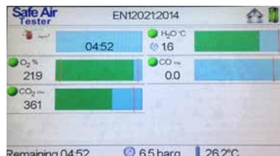
Am Ende des Tests wird der Impaktor-Ergebnisbildschirm angezeigt. Der Impaktor sollte nun aus dem Testanschluss entnommen, der Aufkleber entfernt und ausgewertet werden.
