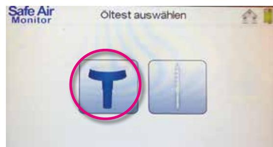
Schließen Sie das Gerät bei geschlossenem Durchflussregelventil an die zu prüfende Luftversorgung an. Setzen Sie zuerst den entsprechenden Adapter in den Tester ein und schließen Sie dann den Versorgungsschlauch an den Adapter an. Ein Test kann bei jedem Druck zwischen 2 und 10 bar durchgeführt werden.
