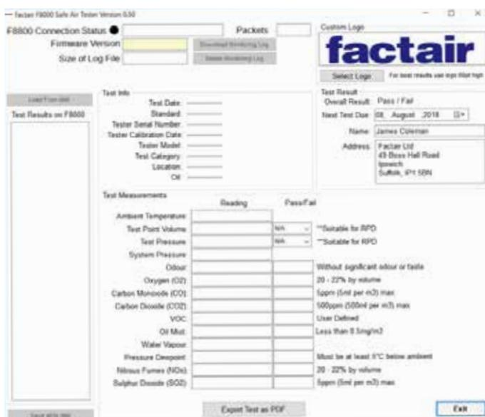
Um die Testergebnisse vom Medic-Air-Tester auf die PC-Software zu übertragen, schalten Sie den F8004 ein, schließen Sie das USB-Kabel zwischen dem F8004 und Ihrem PC an und öffnen Sie die Software der Multi-Air-Tester-Ergebnisse der F8004-Serie.
