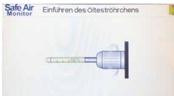
Der Test beginnt nun und die Dauer wird als Countdown zusammen mit Druck, Umgebungstemperatur, Kohlendioxid, Kohlenmonoxid, Sauerstoff, nitrosen Dämpfen, Schwefeldioxid und Drucktaupunkt angezeigt. Wenn ausgewählt, wird auch der VOC-Inhalt angezeigt.
