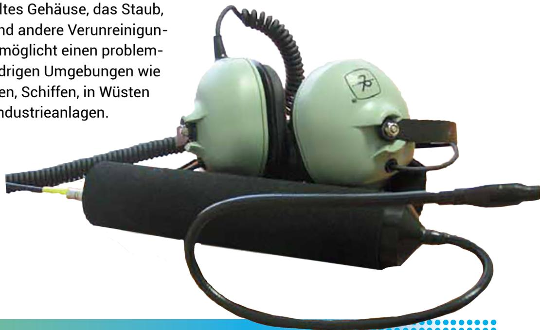
Der Ultraschall-Detektor-Auditor stellt sicher, dass jedes empfangene Signal, einzeln analysiert und im Audioband einschließlich seiner ursprünglichen Intensität rekonstruiert wird. Durch die Verfolgung dieser Geräusche können Leckagen, Lichtbögen und andere mechanische Probleme innerhalb von Minuten lokalisiert werden. Werden die Leckagen behoben, spart dies Zeit, Geld und reduziert den Produktivitätsverlust.
