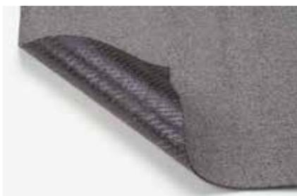
Système composé d'une membrane d'étanchéité Etendard D, en bitume élastomère SBS d'épaisseur 4 mm, soudée en plein sur le support, et de deux couches de protection Etendard E, en bitume élastomère avec armature renforcée, et soudées sur Etendard E.
