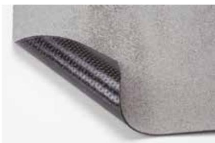
Membrane en bitume élastomère SBS d'épaisseur 4 mm, soudée en plein sur le support, et recevant directement une contre-chape lourde en enrobé d'épaisseur 30 mm minimum. Les enrobés peuvent être mis en œuvre à chaud ou à froid.
