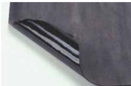
Membrane en bitume élastomère SBS d'épaisseur 4 mm, soudée en plein sur le tablier de l'ouvrage, et recevant directement une contre-chape lourde de 25 mm d'asphalte.
