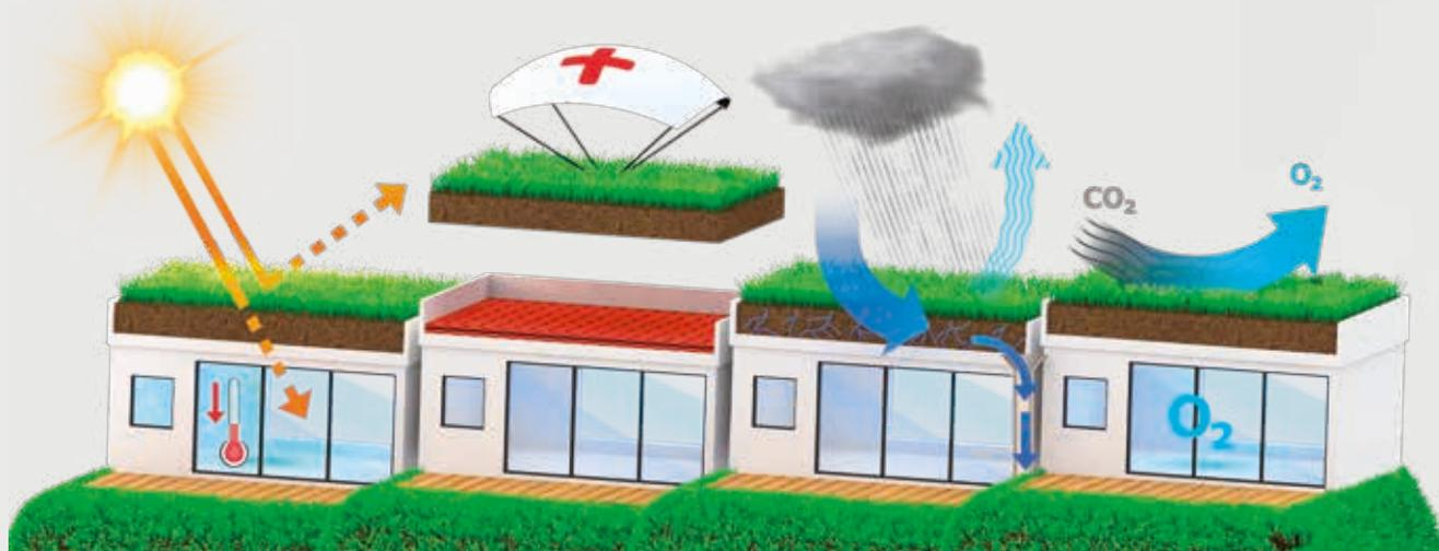
À la différence des toitures-terrasses jardins traditionnelles, la végétalisation extensive et semi-intensive se caractérise par son très faible poids rapporté qui permet d'étendre son emploi sur des toitures étanches inaccessibles comportant une structure légère en tôles d'acier nervurées ou en bois.
