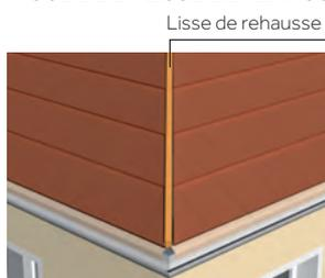
La lisse de rehausse doit être positionnée de telle sorte que la faîtière/arêtier repose sur le nez des tuiles en position la plus haute.
