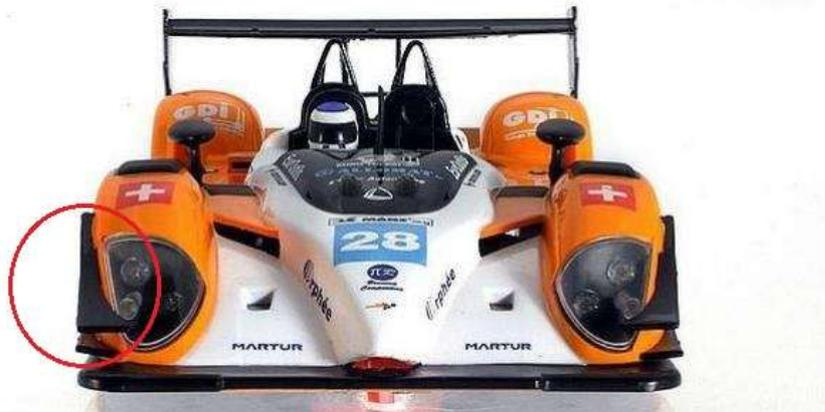
Se permite eliminar el entrante de la entrada de aire lateral traseras de las carrocerías antiguas con el fin de que se pueda montar la suspensión lateral con los chasis Evo-6 del Radical.
